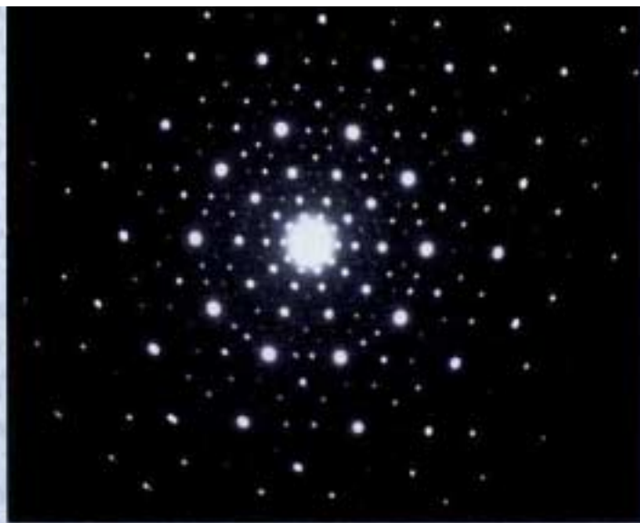
Cliché de diffraction des rayons X d'un quasi-cristal
